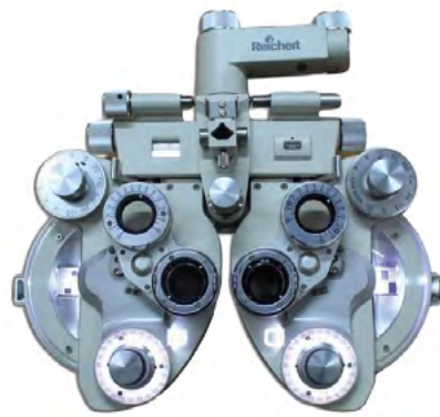
Ryc. 3. Foropter Reichert (wcześniej American Optical) Ultramatic RX Master 11656 – bardziej nowoczesna wersja foroptera z 1967 roku [źródło: https://visionequipmentinc.com/product/reichert-ultramatic-rx-master-11656-illuminated-phoropter/]
