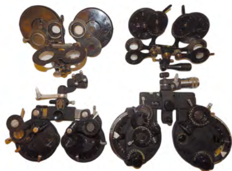
Ryc. 4. Foroptery DeZeng, American Optical: na górze model 570 z 1917 roku, na dole aparaty o numerze 589 z 1934 roku i 590 z 1948 roku [2]
