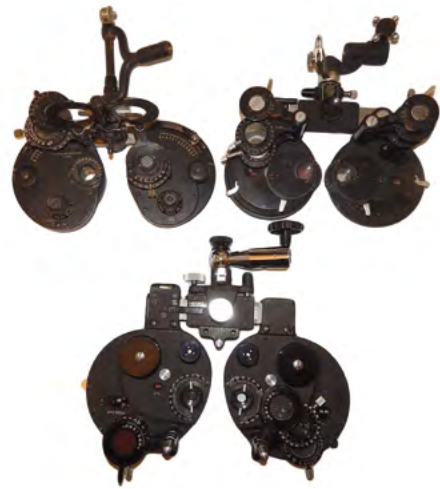
Ryc. 2. Foropter z 1934 roku. Na górze po lewej: Genophthalmic Refractor; na górze po prawej: American Optical 589 Phoropter; na dole: urządzenie firmy Bausch+Lomb [2]
