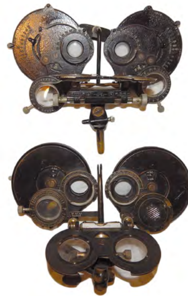
Ryc. 1. Pierwsze foroptery z 1917 roku. Na górze: ski-optometer Woolfa. Na dole: Phoro-Optometer DeZenga, model 570, Camden [2]
